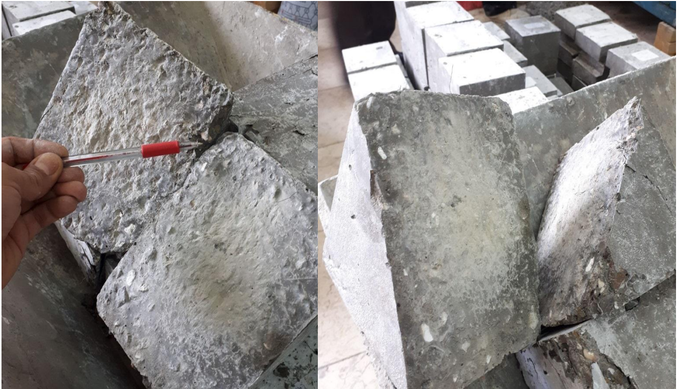
شکل ۳-۱۰- سطح مقطع نمونه ها بعد از شکست برشی مورب
