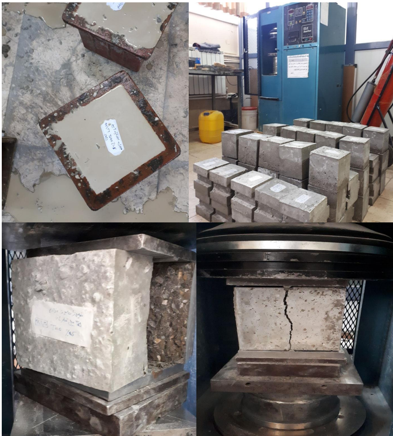
شکل ۳-۱۴- روند ساخت نمونه های کششی تحت فشار
