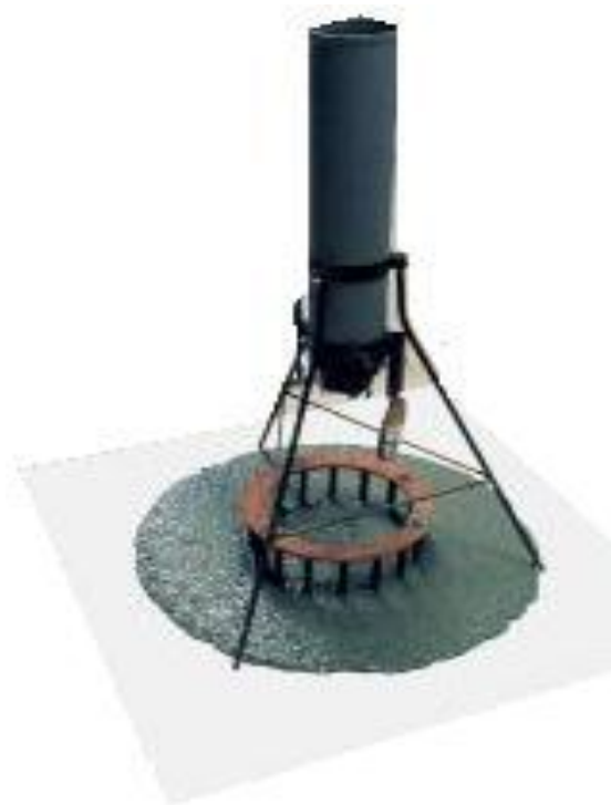
شکل ۲-۱۹- ترکیب دستگاه آزمایش اورمیت و حلقه J [۱۸]
