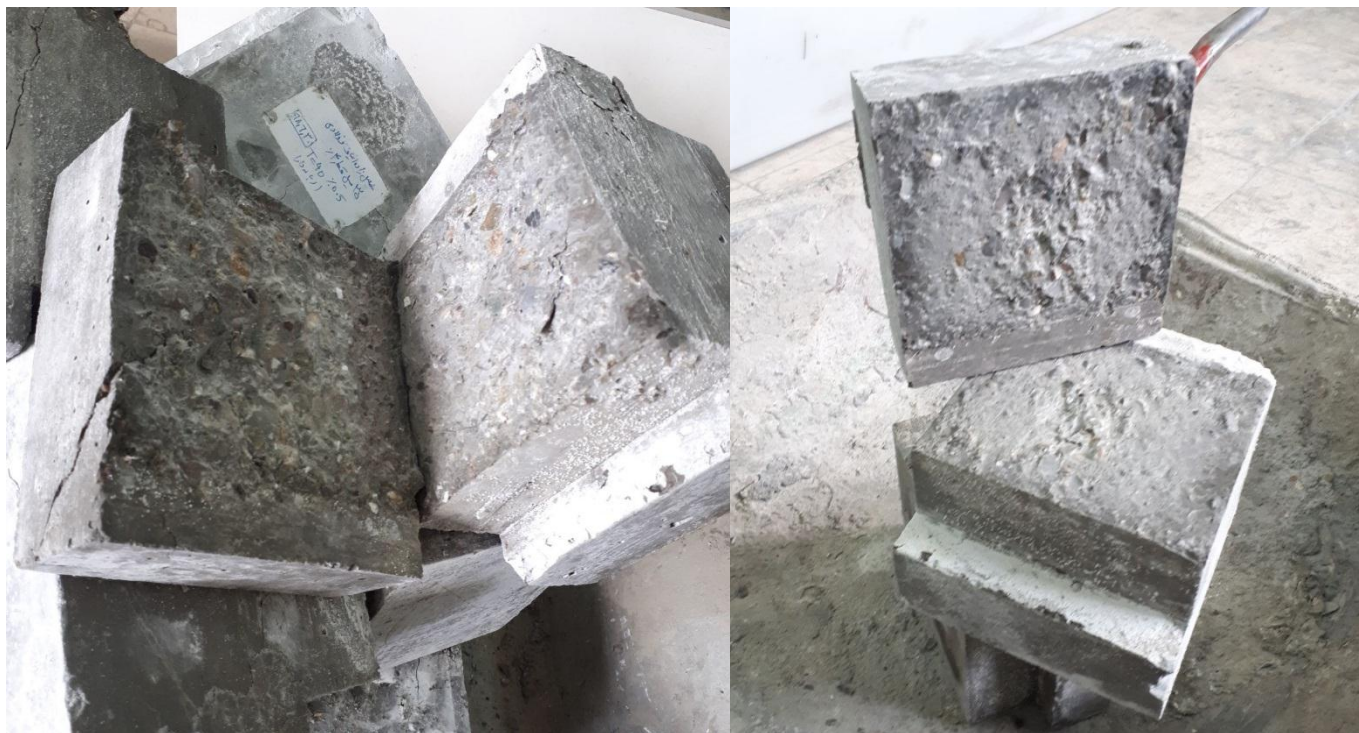
شکل ۳-۱۳- سطح مقطع نمونه بعد از شکست برشی مستقیم
