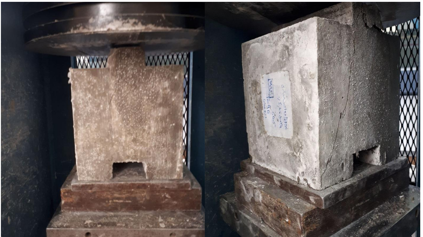
شکل ۳-۱۲- روند ساخت نمونه های برشی مستقیم
