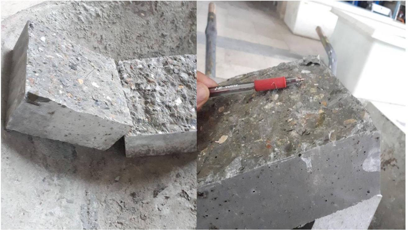
شکل ۳-۱۵- سطح مقطع نمونه بعد از شکست کششی تحت فشار
