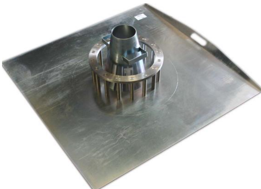
شکل ۲-۵- دستگاه مخروط اسلامپ و صفحه پایه و حلقه J [۱۷]
