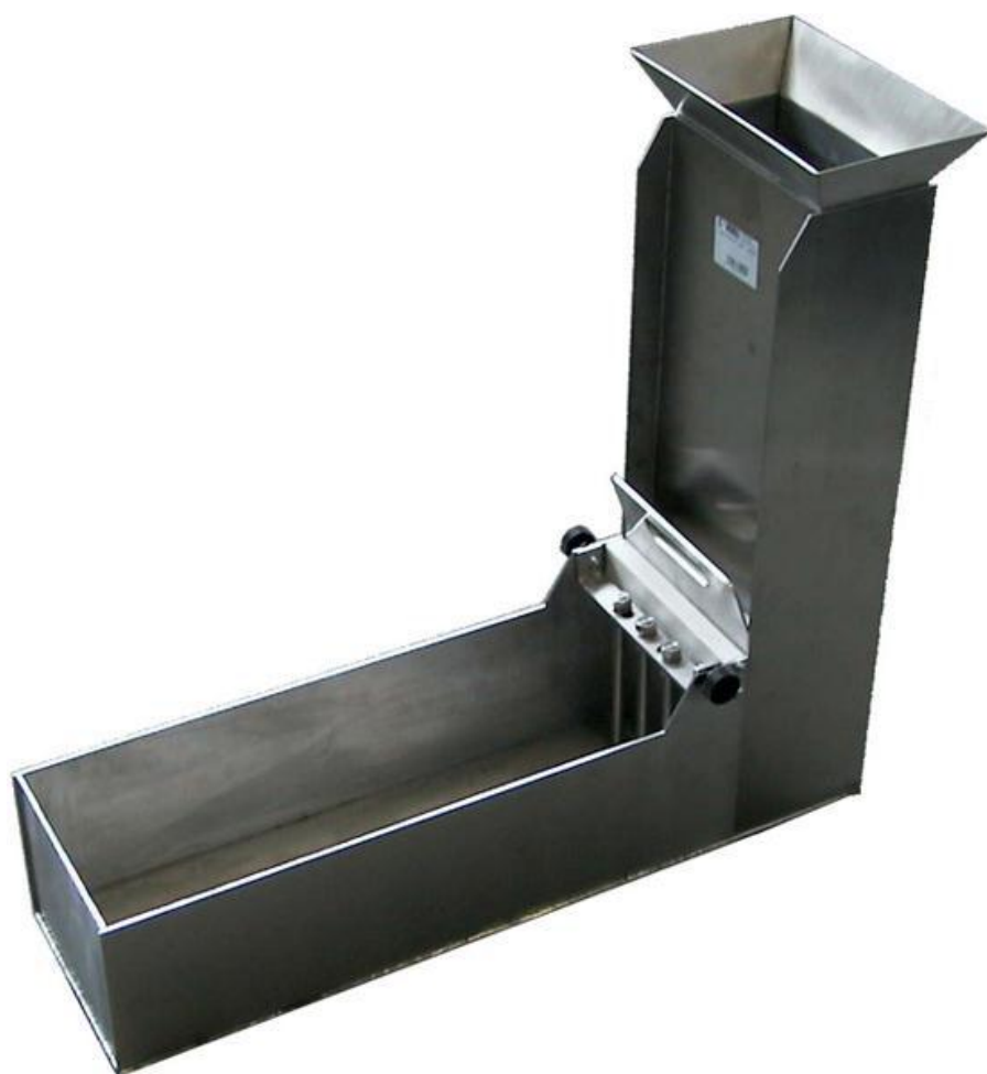
شکل ۲-۱۱- دستگاه استاندارد آزمایش جعبه L [۱۸]
