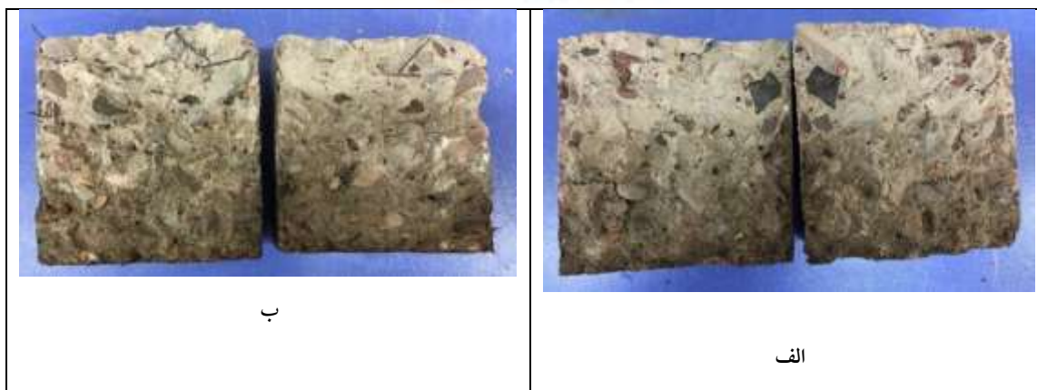
شکل ۱۵: پروفیل عمق نفوذ آب در دمای ۵۰۰ درجه سانتیگراد (الف) نمونه St25، (ب) نمونه St50.
