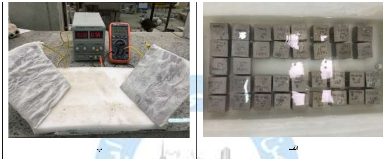
شکل ۱۰: آزمون مقاومت الکتریکی (الف) غرقاب نمونه‌ها، (ب) تجهیزات آزمایش مقاومت الکتریکی
