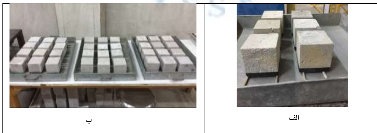
شکل ۱۲: تصویر آزمایش جذب آب سطحی (الف) آماده سازی نمونه ها در سینی پیش از ریختن آب، (ب) نمونه های حین آزمون.
