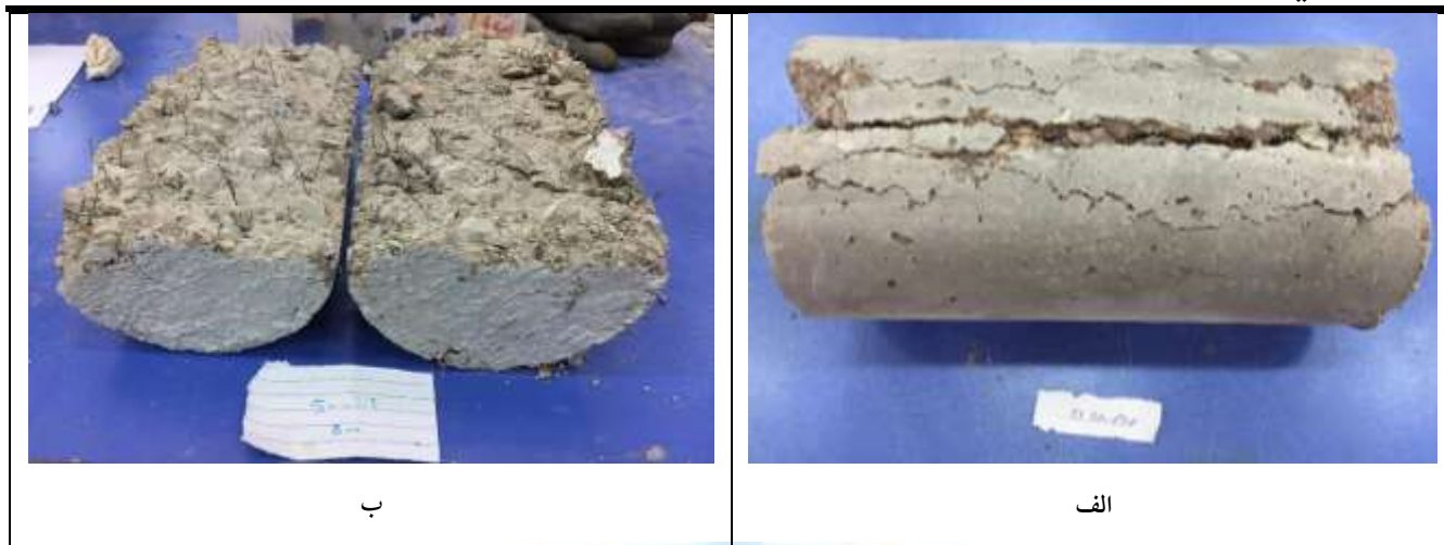
شکل ۸: تصویر نمونه St50 پس از شکست کششی (الف) دمای ۶۵۰ درجه سانتیگراد، (ب) دمای ۸۰۰ درجه سانتیگراد.
