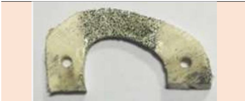
شکل (۴) - ایجاد الگوی لک روی قسمت طول موثر ۸ نمونه‌ها (منطقه‌ای که بیشترین کششی را دارد) به منظور انجام روش برهم‌نگاری تصاویر دیجیتالی
